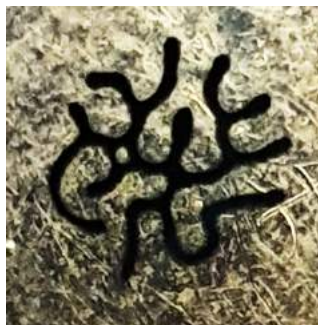
Figure 2 – Un ferrofluide placé entre deux plaques et soumis à un champ magnétique statique puis tournant prend des formes très énigmatiques, et qui sont totalement différentes si le champ tournant est appliqué en premier.
