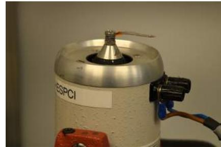
Figure 7 – Moteur vibrant où est fixée l'aile de libellule
